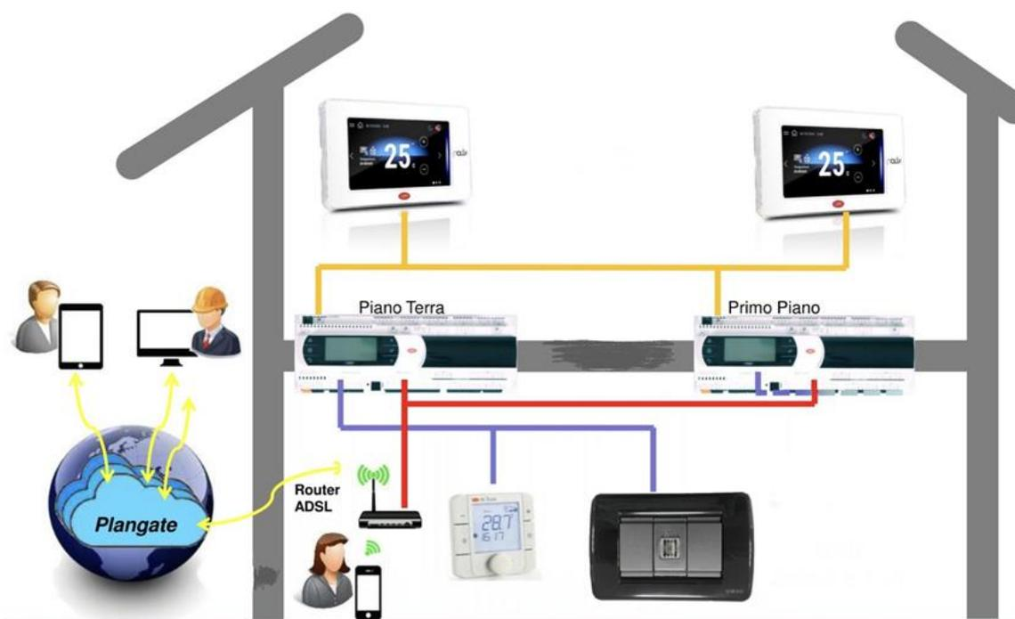
AIRNET propone la nuova generazione di regolazione per la gestione ed il controllo di impianti radianti per riscaldamento o per riscaldamento raffrescamento.
